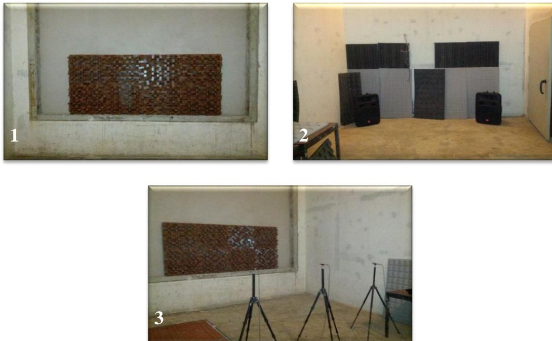
Figura 6.24 – Material e equipamento usado na medição do aumento do grau de difusão numa sala pequena (HCS) (fotos do autor).
