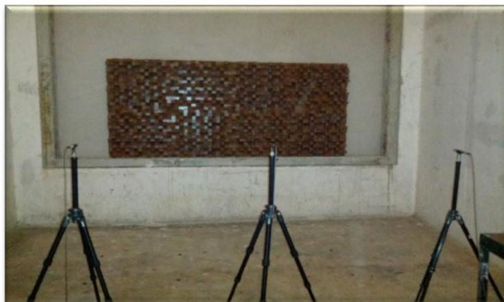
Figura 6.23 – Disposição dos oito difusores na parede frontal da câmara reverberante E1 (foto do autor).
