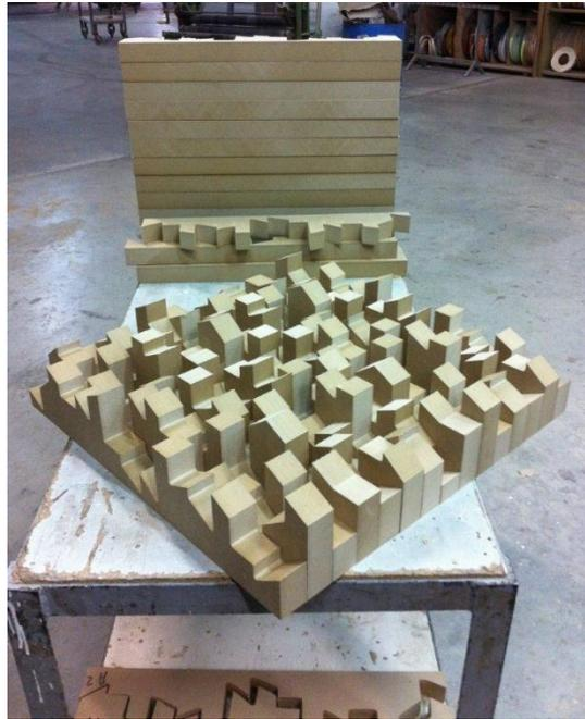
Figura 5.32 – Montagem do difusor – disposição ordenada das *Lines* (foto fornecida pela *Castelhana & Ferreira*).
