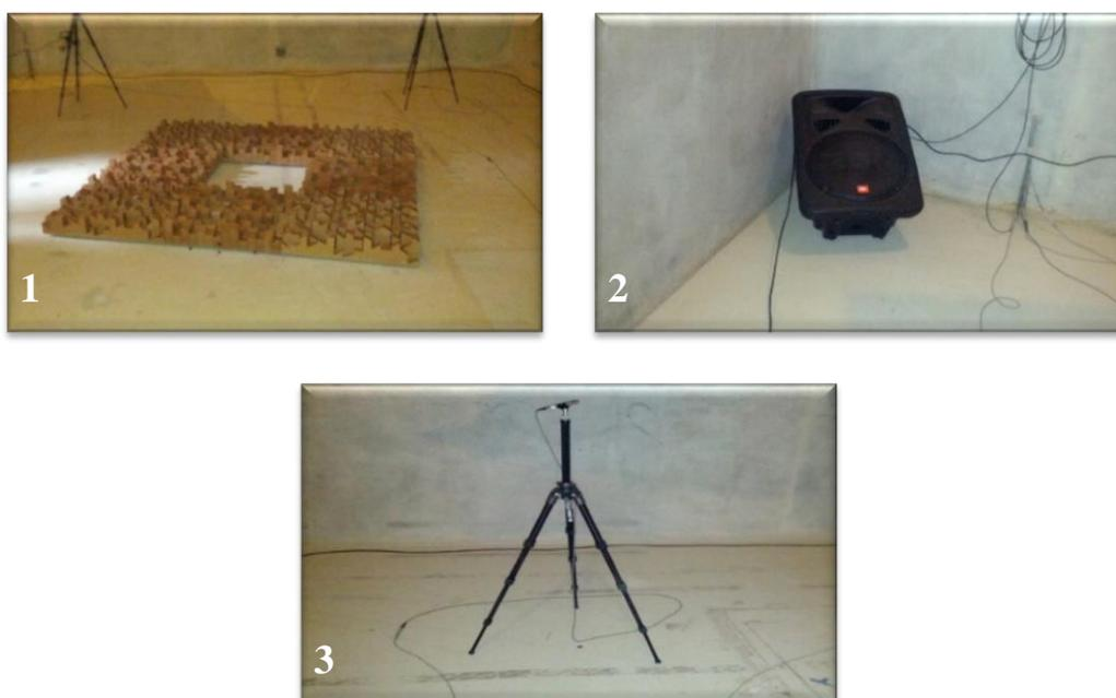
Figura 6.12 – Material usado na medição do coeficiente de dispersão [fotos do autor].
