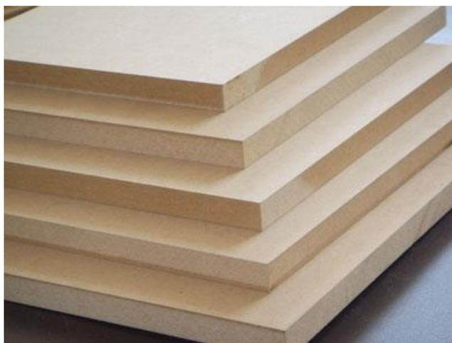
Figura 5.30 – Placas de fibra de madeira de média densidade – MDF [32].
