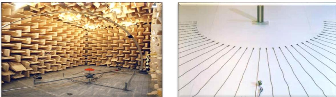
Figura 6.2 – Esquemas de montagem laboratorial para medição do coeficiente de difusão conforme AES-4id-2001. À esquerda sistema de medição de uma superfície difusora 1D, com goniómetro 2D. À direita sistema de medição de um difusor 2D, com um goniómetro 3D [19].
