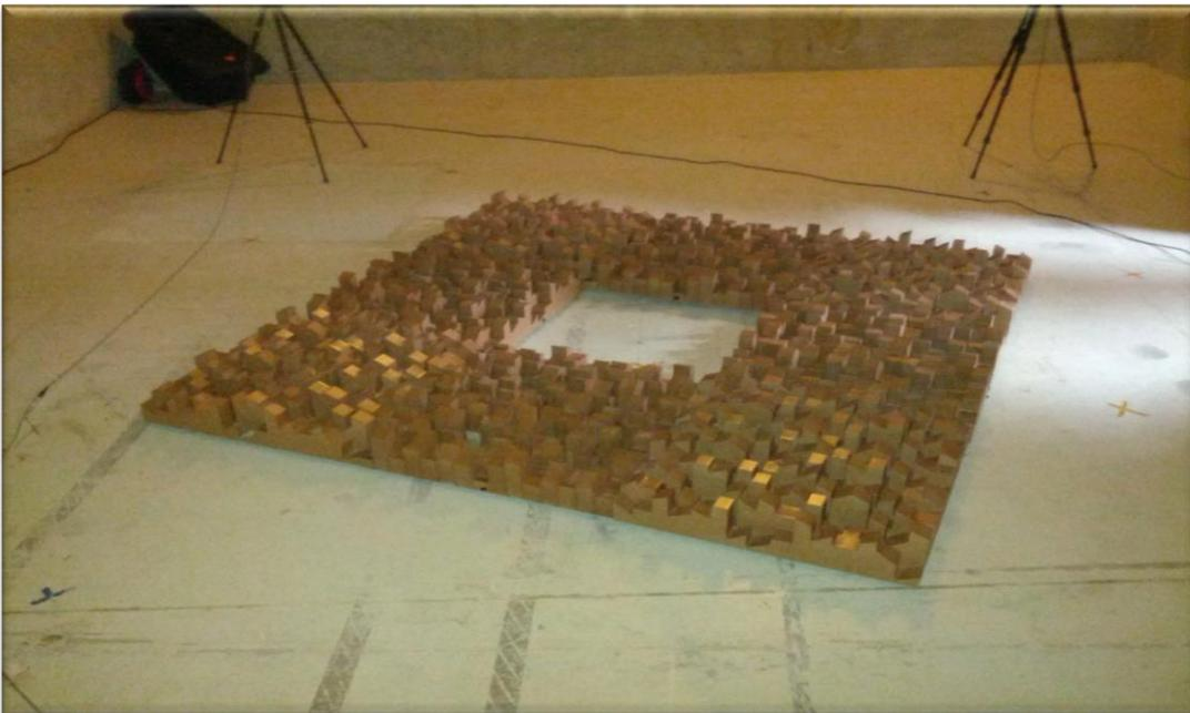
Figura 6.11 – Amostra quadrada (oito painéis) colocada diretamente no piso da câmara reverberante (o espaço no centro deve-se à falta do nono painel não fornecido pela *Castelhano & Ferreira*).
