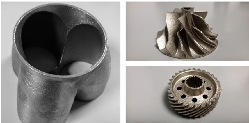
Figura 15 – Peças complexas impressas tridimensionalmente [31]
