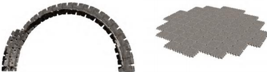
Figura 74 – Representação de elementos formados por painéis modulares pré-fabricados [112]
