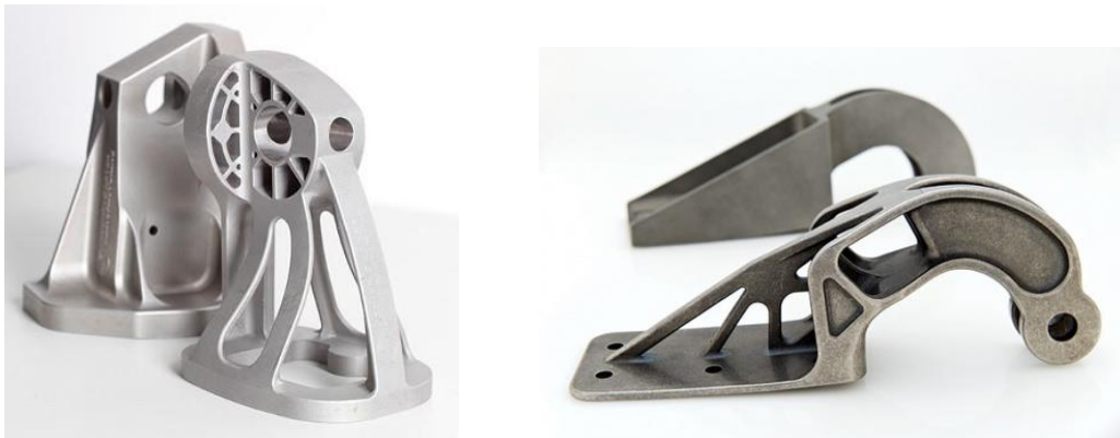
Figura 14 – Peças normais vs peças com design otimizado impressas tridimensionalmente [29], [30]
