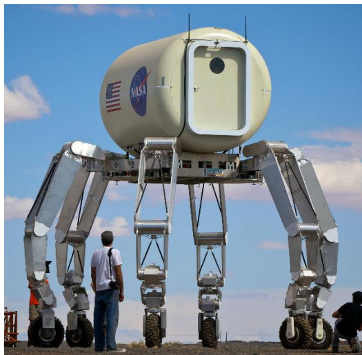
Figura 72 – Protótipo teste do ATHLETE [113]
