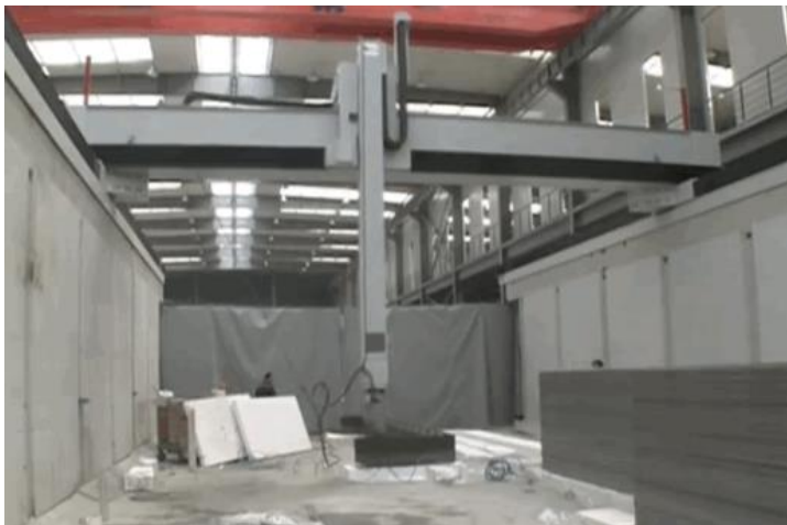
Figura 58 – Impressora 3D desenvolvida pela Winsun [95]
