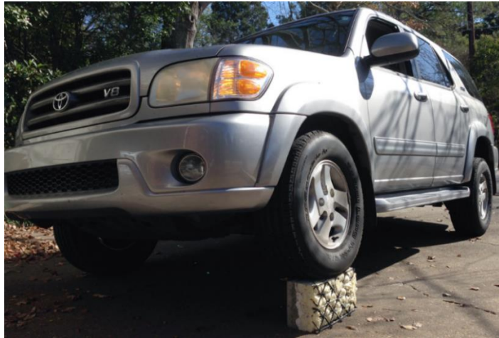
Figura 31 – Exemplo da resistência estrutural de um modelo de pequena escala da parede [58]
