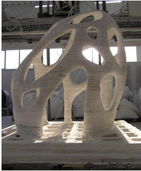
Figura 56 – Radiolaria: estrutura executada pela D-Shape, que ilustra a liberdade de forma alcançável [90]
