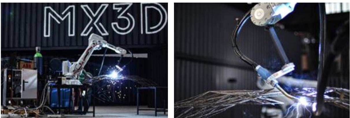
Figura 51 – Braço robótico e detalhe do processo de fabrico [84]
