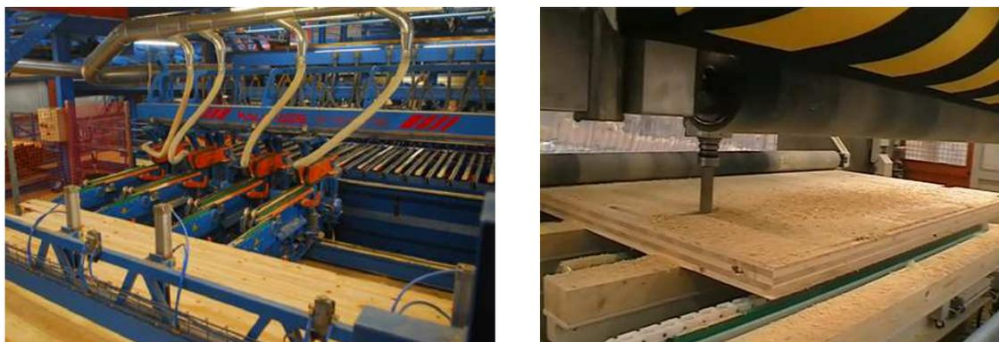
Fig. 3.6 e Fig. 3.7 – Corte dos painéis [21]
