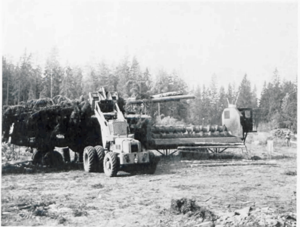
Foto 5 De schroef. Een "limber/bucker" die op de bosweg opereert en meerdere bomen tegelijk kort en snoeit.
