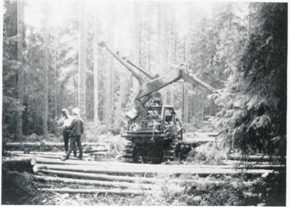
Foto 4 Het lieren van langhout loodrecht op een rijpad bij de langhoutmethode. Onderlinge afstand der rijpaden b.v. 50 m.
