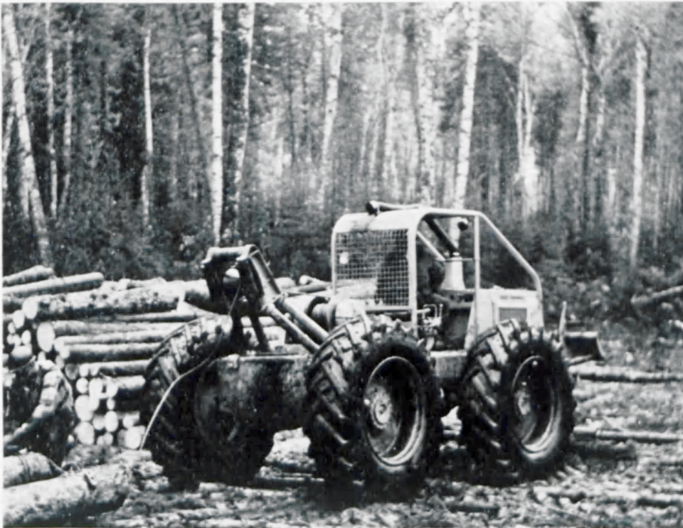
Foto 3 Gelede trekker met vierwielaandrijving voor het uitslepen van langhout met behulp van lier en uitsleepkabels.
