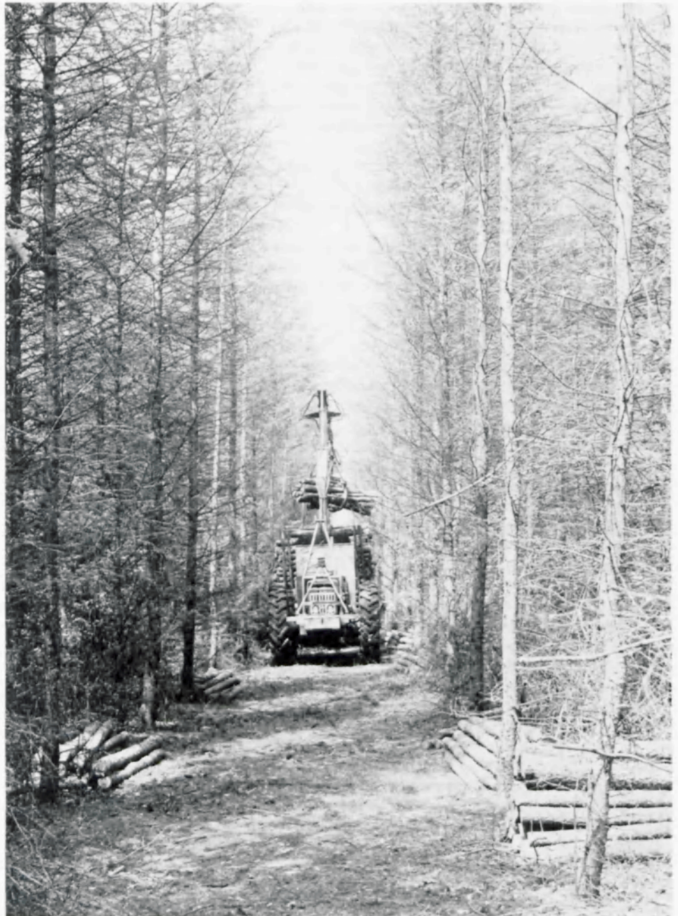
Foto 1 Opstandsontsluiting met rijpaden op onderlinge afstand van ca 20 m bij de sortimentmethode. Afvoer door een twee-assige trekker met kraan en bogietrailer. Het hier afgebeelde rijpad van 3 m breed is te smal; de breedte moet 4 m zijn.
