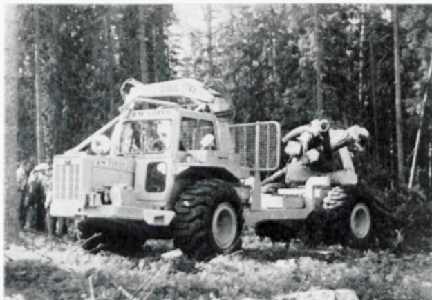
Foto 6 Een "feller/skidder" voor het vellen en uitslepen van dunningshout. Theoretisch bewerkstelligt deze machine, tezamen met een "limber/bucker" zoals bijvoorbeeld de "schroef" de volledige mechanisatie van de oogst van standaardsoortiment volgens de boommethode.
