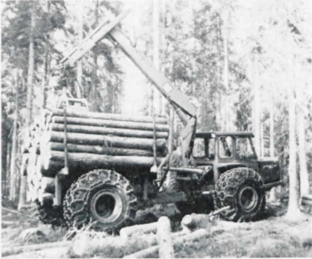
Foto 2 Het uitrijden van sortiment langs een rijpad met een twee-assige gelede trekker, met vierwielaandrijving, kraan en 12 ton laadcapaciteit.
