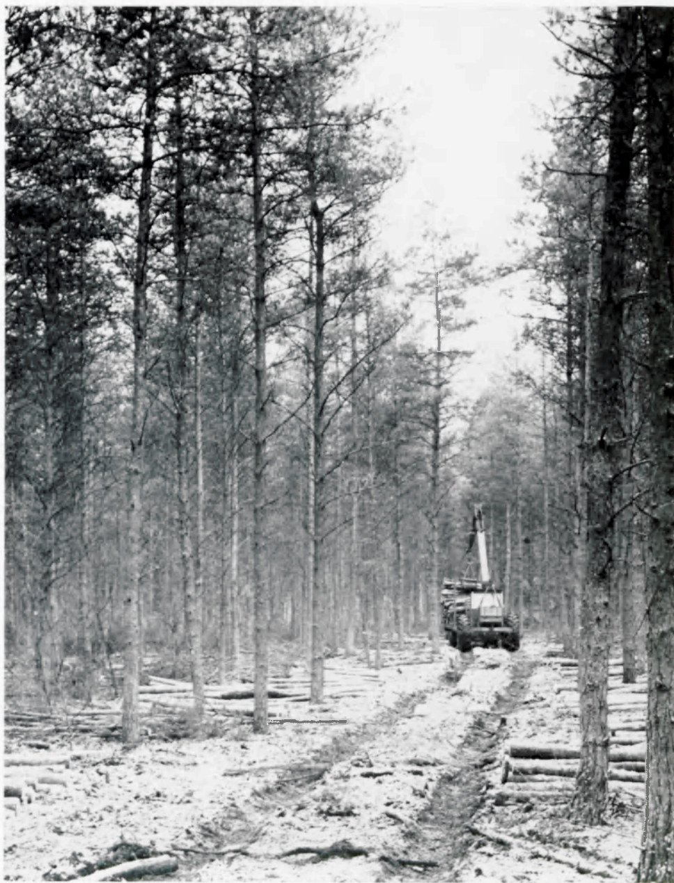
Afvoer van sortiment met trekker, kraan en bogietrailer; breedte der rijpaden 4 m.
