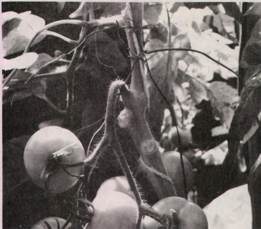
Figuur 7. Opstelling van vruchttemperatuurmeting met thermokoppeldraad in een tomatengewas.
