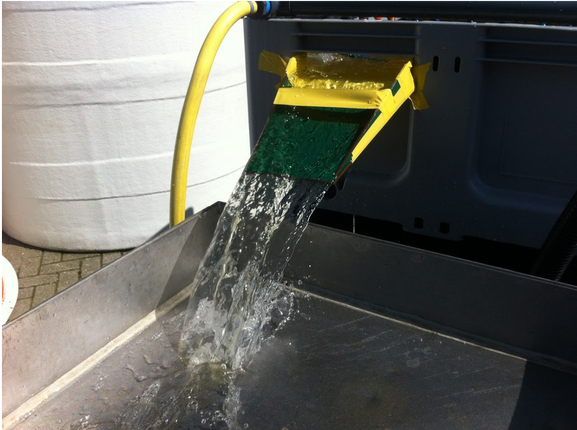
Figuur 2. Detail van overstroom uit Benthos Separator prototype V2 en V3 (foto: Joop Coolen/WMR).
