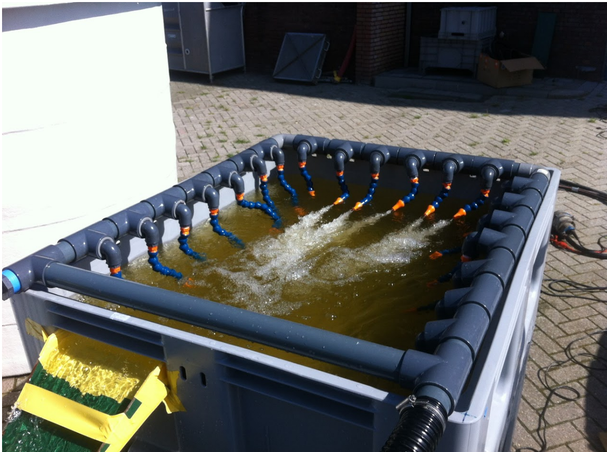
Figuur 4. Benthos Separator prototypes V2 en V3 met 50 mm PVC-ringleiding en 20 loc-line pijpjes (foto: Joop Coolen/WMR).
