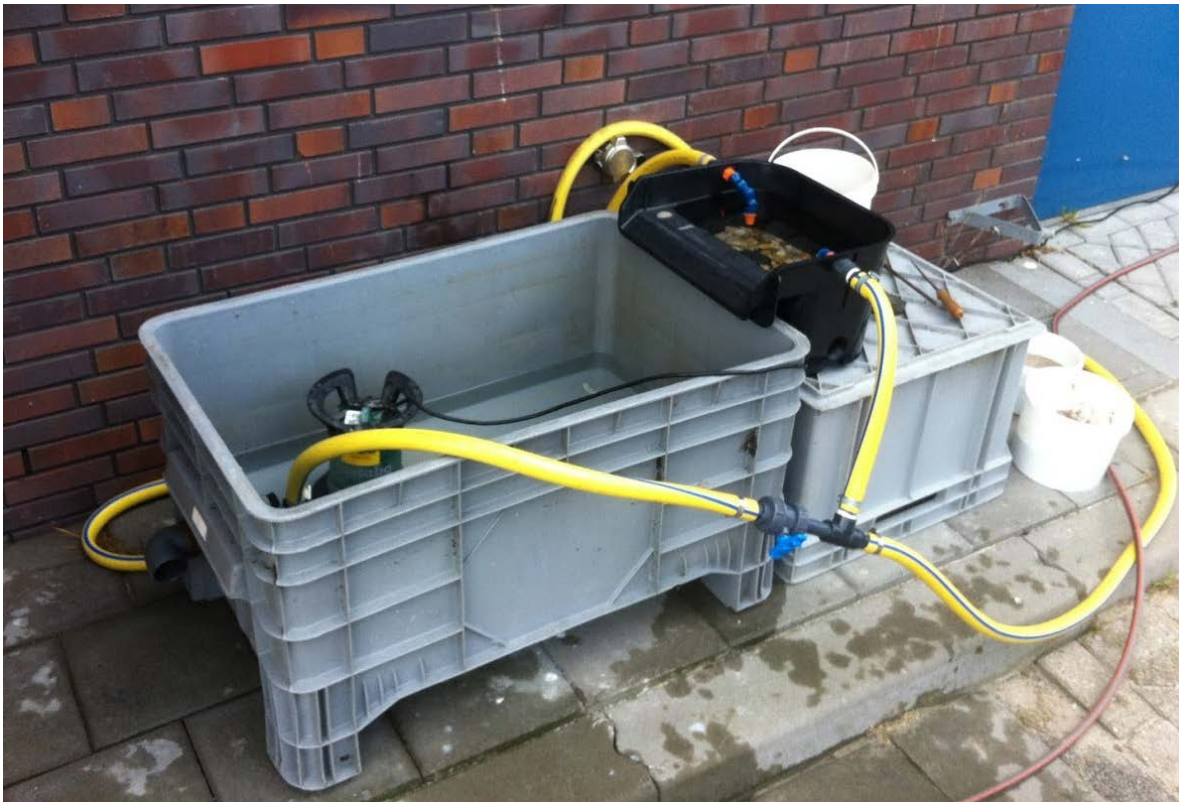
Figuur 1. Opstelling schaalmodel. Zwarte bak: vijverbak, waarin sediment wordt toegevoegd. Blauwe pijpjes in de vijverbak: loc-line pijpjes. Grize bak: opvangbak voor sediment, met daarin de pomp met slangen om water terug te pompen naar de vijverbak (foto: Joop Coolen/WMR).
