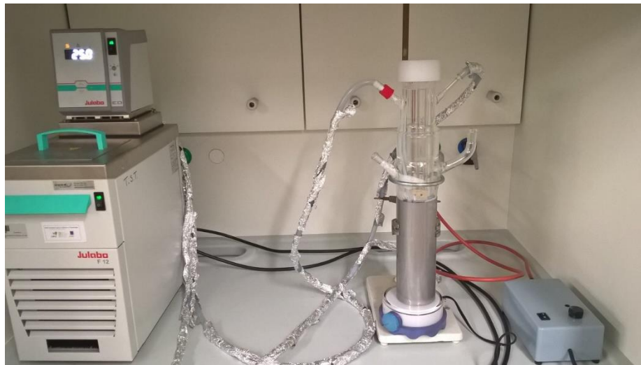
Figura 3 – Montagem experimental incluindo o fotoreator/lâmpada e o banho de refrigeração
