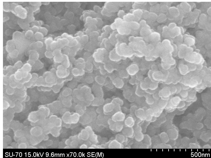
Figura 6 - Imagem de microscopia eletrónica de varrimento do TiO 2 P25
