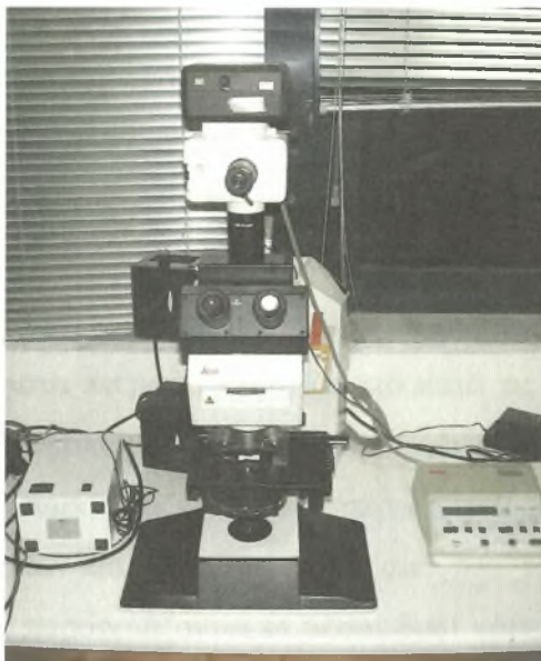
Εικόνα 8. Μικροσκόπιο αντίθεσης φάσης (Leica DRMB) για μέτρηση μορφολογικών χαρακτηριστικών.
