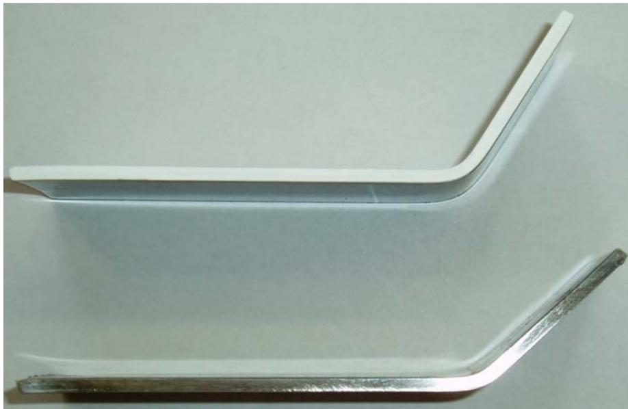
Figura 4.25 Perfil superior pintado con el rotulador marcador de color blanco. Perfil inferior sin pintar, únicamente pulido.
