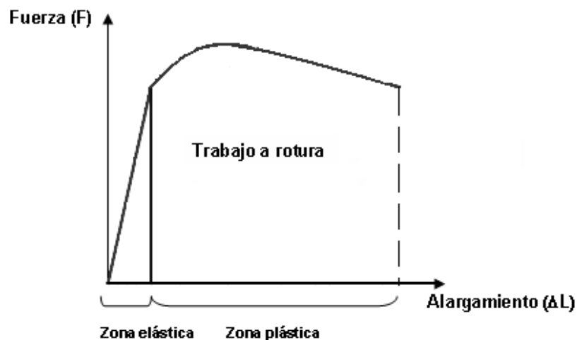
Figura 3.11. Trabajo a rotura determinado a partir de la curva fuerza-alargamiento.
