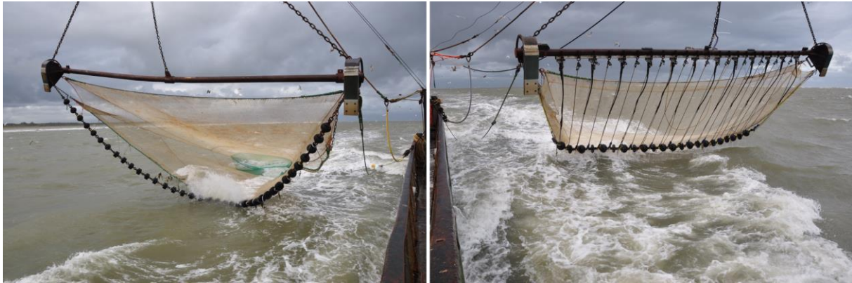
FIGUUR 3-4: AFBEELDINGEN VAN HET GEBRUIKTE TRADITIONEEL VISTUIG (LINKS) EN HET PULSVISTUIG (RECHTS). LINKS DE TRADITIONELE KLOSSENPEES MET 37 KLOSSEN (CA. 400 KG) IN EEN ROND NET, RECHTS DE GEREDUCEERDE, RECHTE KLOSSENPEES (CA. 250 KG) MET 12 KLOSSEN EN 10 RUBBERSCHIJVEN IN EEN VIERKANT NET MET 12 ELEKTRODEN EN 23 TREKONTLASTERS.
