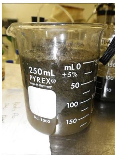
**Figure 25 : Coagulation/floculation du digestat**
