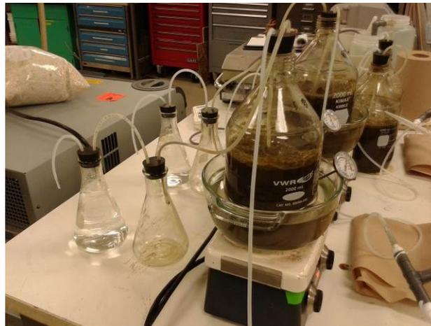
Figure 18 : Montage expérimental de l'unité de stripage (vue de côté)
