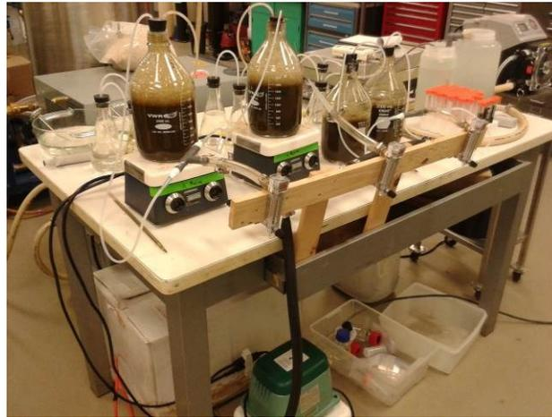
Figure 17 : Montage expérimental de l'unité de stripage (vue de face)
