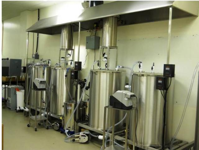
Figure 11 : Système de digestion anaérobie du CNETE.
