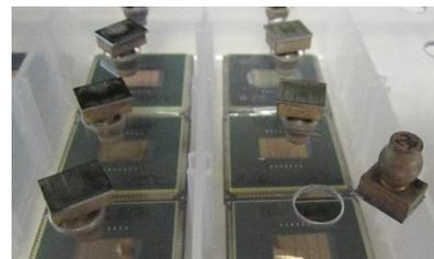
Figure 3.21 : Pièces arrachées prêtes pour l'analyse
