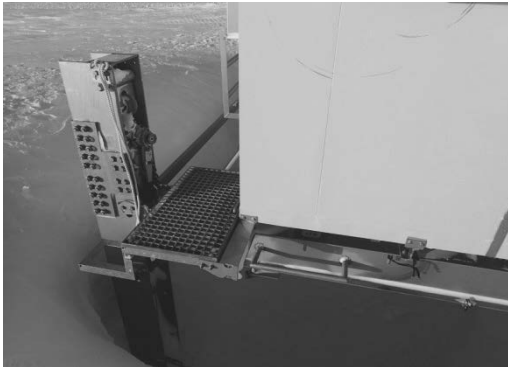
ジャッキアップ用レバーブロック
