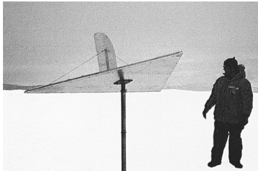
写真Ⅲ.6.2.3-3 マクマード基地(アメリカ) のペガサス飛行場に設置された三角形パネル (Lang, R.M. et al., 1999. Passive snow removal at the Pegasus Runway, McMurdo, Antarctica より抜粋)
