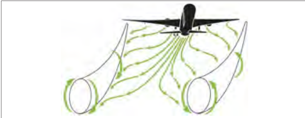
Figure 0.1 Schématisation de l'enroulement tourbillonnaire menant à la formation d'une paire de tourbillons contrarotatifs de sillage d'avion. ( www.airlinepilotchatter.com )
