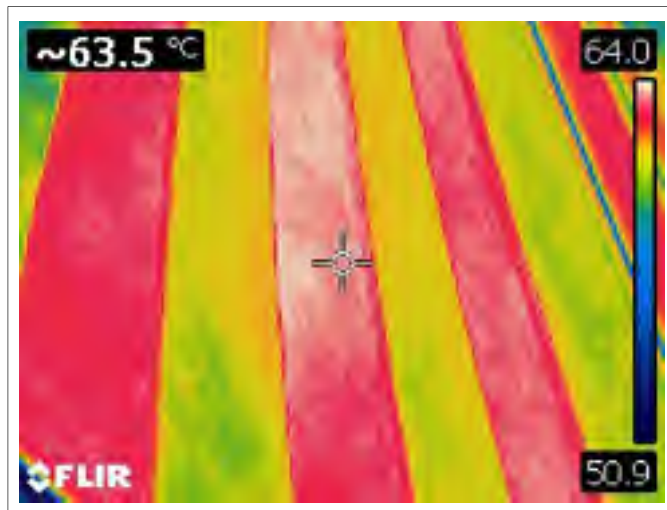
Figure 2.3 Relevé des écarts de températures entre les bandes bleues et jaunes de la tente
