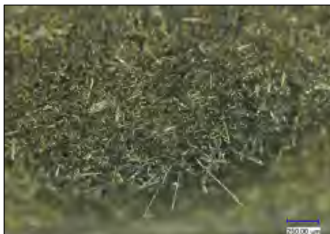
Figure 1.35 : Copeau / Pâte formée de matrice fondue et de fibres courtes
