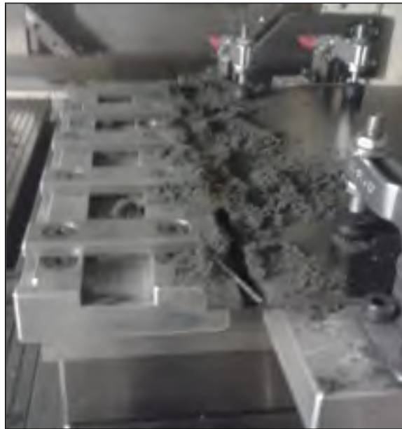
Figure 1.28 : Copeau sous forme de pâte (produit par l'outil usé)
