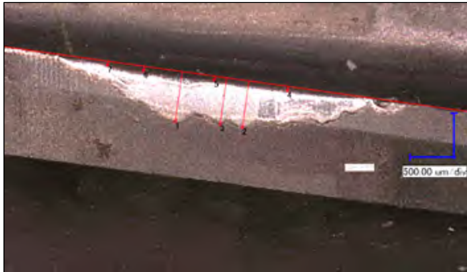
Figure 1.20 : Usure en dépouille d'un outil usé ( V_b = 50 \mu\text{m} , Retrait du revêtement = 550 \mu\text{m} )
