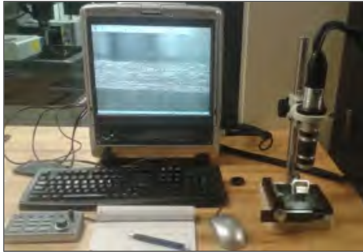
Figure 2.41 : Montage d'analyse de la surface usinée
