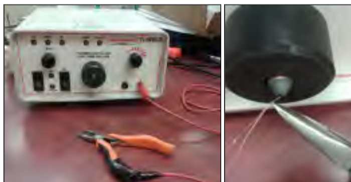
Figure 1.18 : Poste à soudé et soudure du thermocouple
