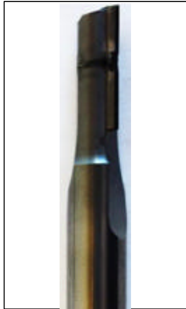
Figure 2.32 : Outil avec plaquettes diamant PCD
