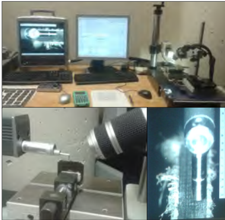
Figure 2.42 : Montage de mesure de rugosité
