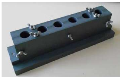
Figure II-2 : Moule cylindrique en PVC utilisé pour le coulage des pâtes de ciment
