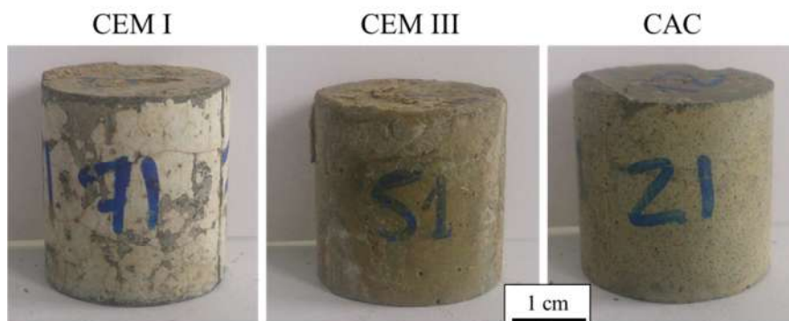
Figure I-5 : Observation macroscopique des coupons après 35 semaines dans le digesteur anaérobie in situ (plateforme de méthanisation SOLIDIA)
