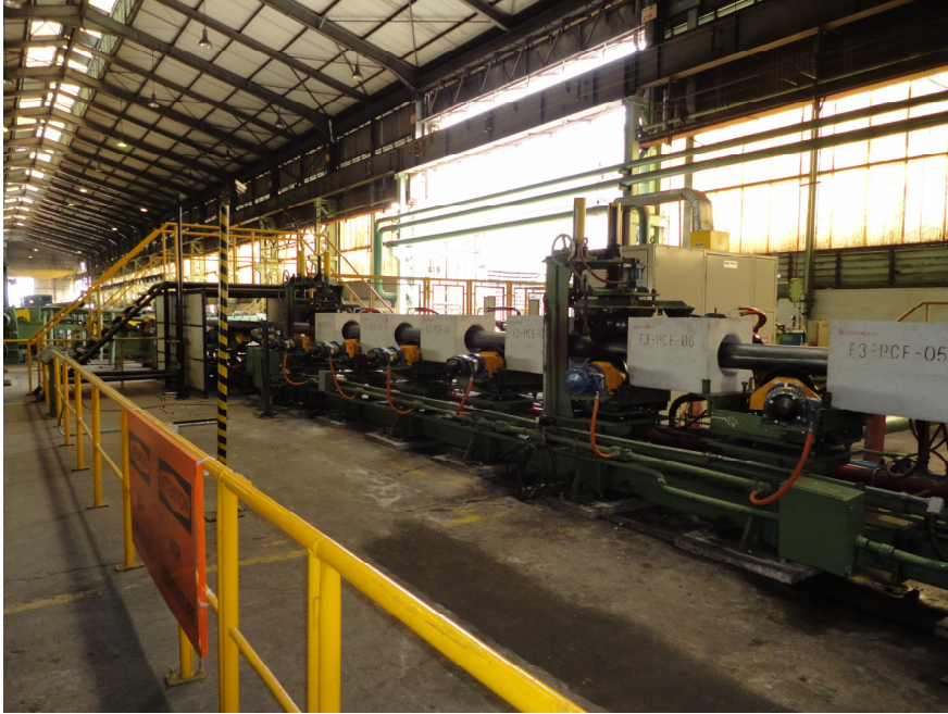
Figura 43 – Fase do Revenido dos tubos OCTG Casing em estudo
