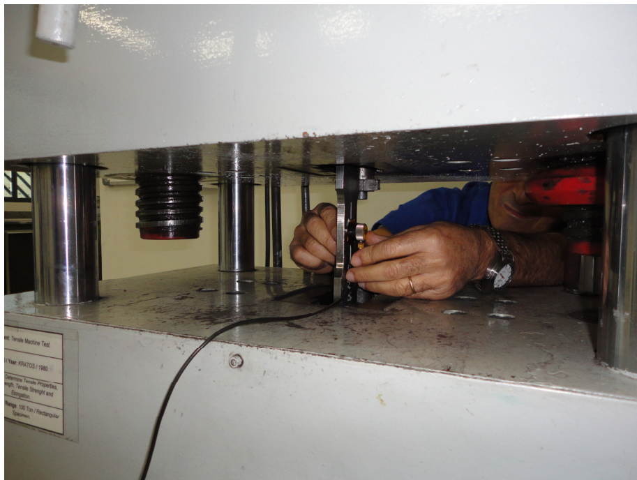
Figura 19 – Ensaio ultrassônico e de carregamento uniaxial de um corpo-de-prova sendo realizados na Máquina de Ensaio Universal da empresa APOLO TUBULARS
