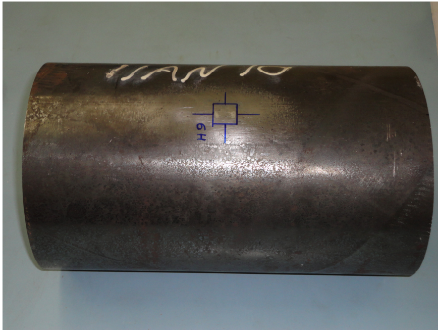
Figura 33 – Em detalhe o corpo-de-prova CP-0 com o ponto de inspeção 6H marcado e identificado (a 180° da solda), posicionado ao centro do comprimento do CP
