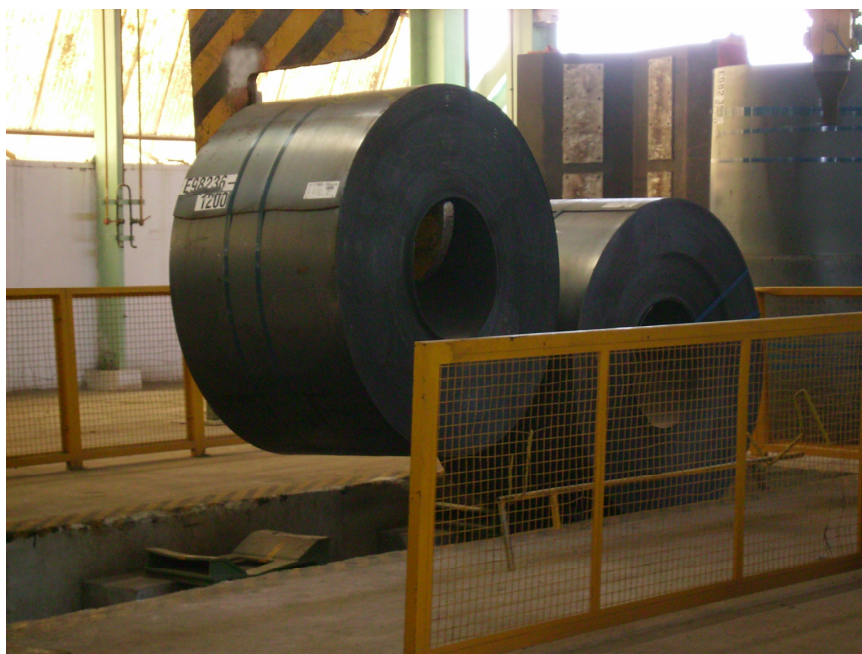
Figura 27 – Bobinas fornecidas pela CSN sendo posicionadas para o processo de corte e rebobinamento em bobinas com a largura final necessária para atender ao diâmetro final desejado na linha de fabricação
