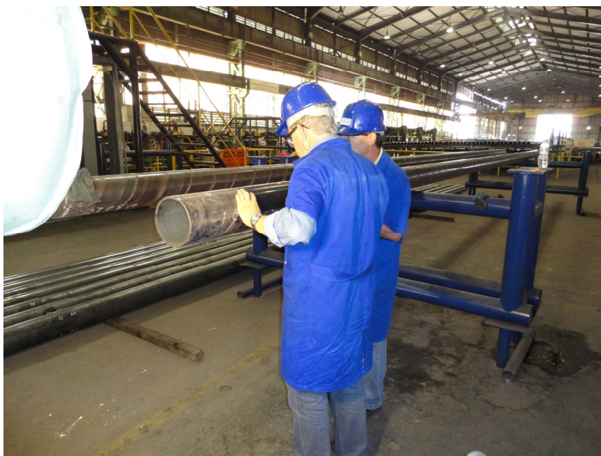
Figura 47 – Remarcação de alguns pontos de inspeção num tubo que apresentaram dificuldade de visualização após o tratamento térmico de têmpera/revenido
