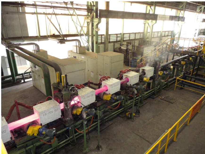
Figura 41 – Tubo em ensaio passando pela fase de Têmpera na etapa de tratamento térmico de têmpera/revenido
