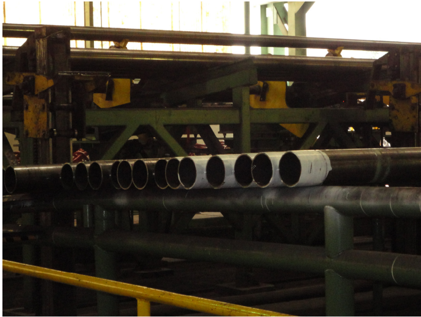
Figura 40 – Os seis tubos com a faixa branca nas extremidades retornando a linha de fabricação antes da etapa do tratamento térmico de têmpera/revenido
