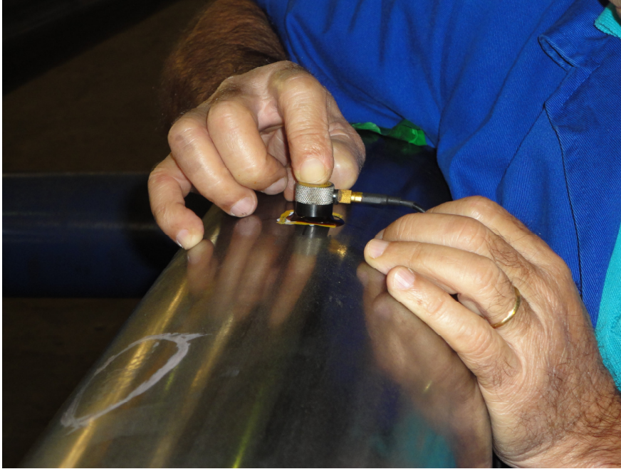
Figura 66 – Transdutor ultrassônico cisalhante de incidência normal sendo posicionado para a captura de sinais ultrassônicos com a onda polarizada na direção transversal
