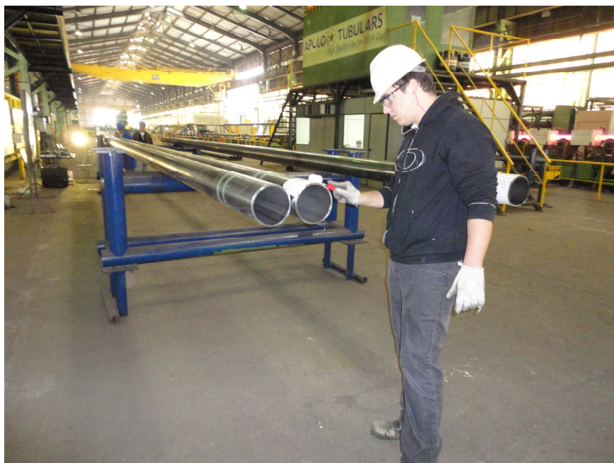
Figura 39 – Pintura das extremidades dos tubos OCTG do tipo Casing em estudo sendo realizada por um técnico da APOLO TUBULARS
