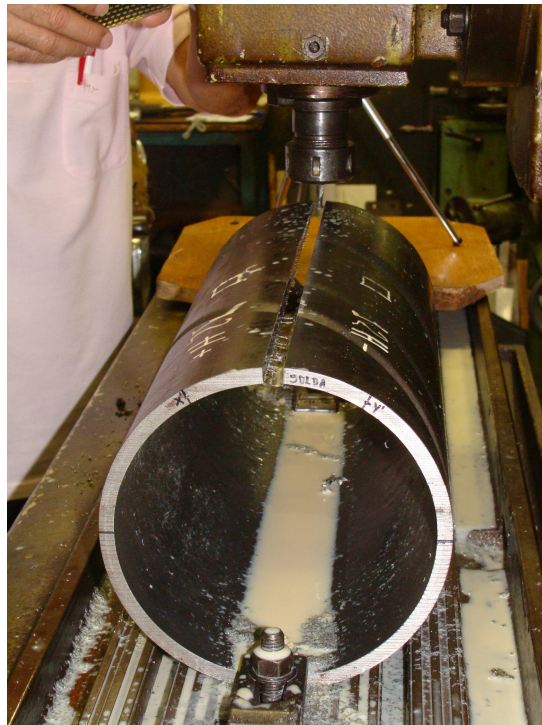
Figura 54 – No detalhe o CP-F com o rasgo (CP-F-RA) e os fixadores especiais confeccionados para este estudo (um em cada extremidade)
