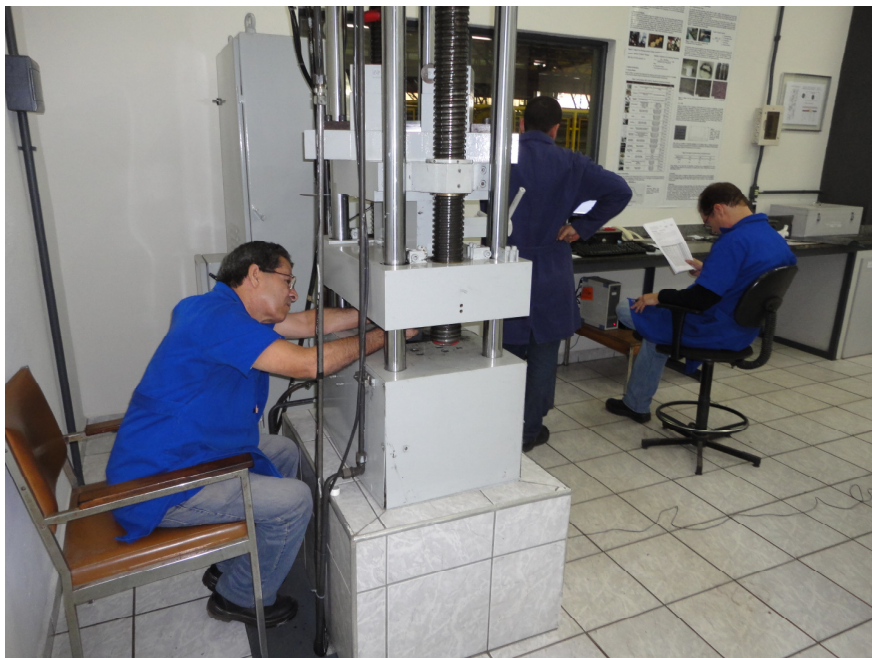
Figura 46 – Máquina de Ensaio Universal e parte da equipe técnica durante o ensaio de carregamento para levantamento da constante acustoelástica do material
