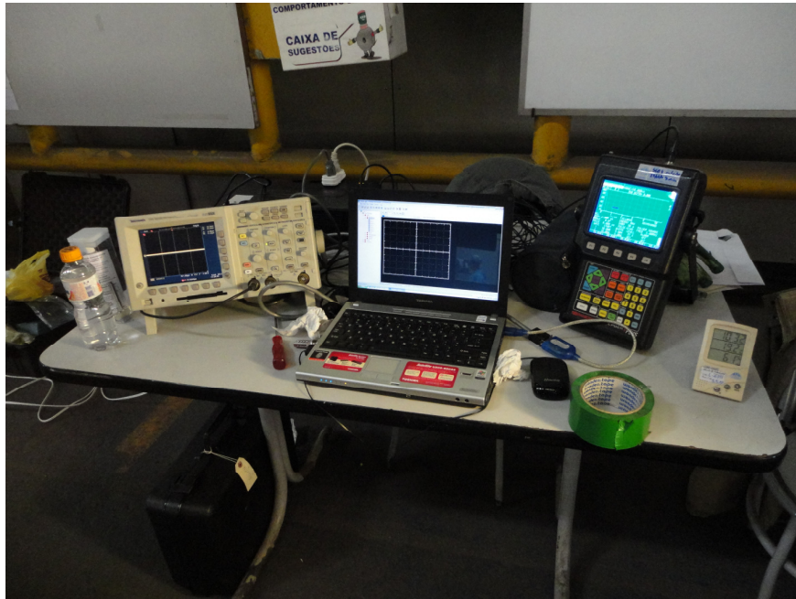
Figura 32 – Sistema ultrassônico usado no estudo na área reservada da linha de produção
