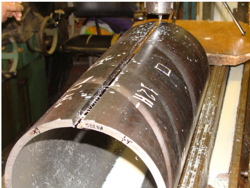
Figura 75 - CP-F logo após a confecção do rasgo por fresamento passando a ser denominado de CP-F-RA
