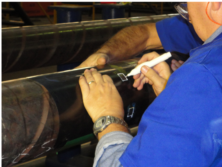
Figura 37 – Marcação dos cinco pontos na região selecionada de um tubo em estudo onde um gabarito é posicionado e utilizado na marcação
