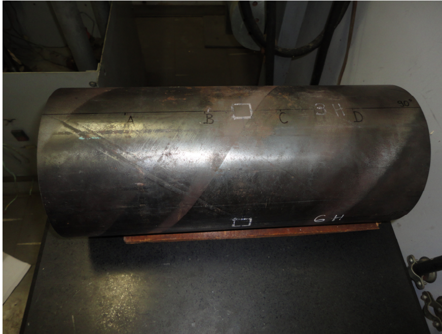
Figura 53 – Corpo-de-prova CP-F mostrando o encontro das quatro seções circunferenciais (A, B, C e D) com as linhas longitudinais traçadas nos pontos 3H e 6H em destaque
