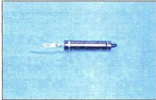
FIG. 4.2 Detector GM LND 713 que é utilizado no Monitor MIR 7026.
