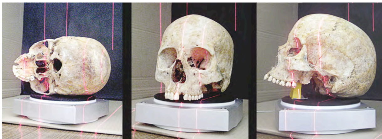
Figura 39 – Crânio do indivíduo C. Sequência ilustrativa do processo de varrimento a laser. A figura revela algumas das múltiplas variações posicionais, necessárias à obtenção da imagem virtual integral do crânio.
