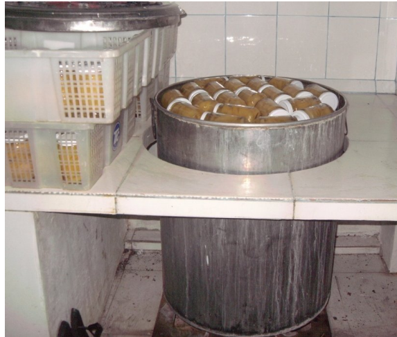
Gambar 4.19. Proses Sterilisasi pada Kemasan Glass Jar
