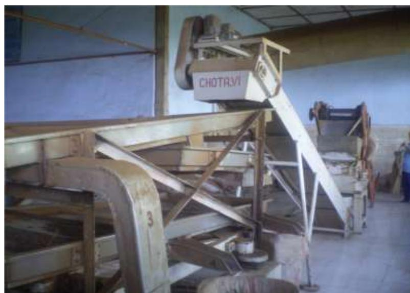
Gambar 4.10 Mesin *Chotta Shifter*
