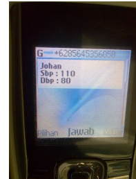
Gambar 13 SMS hasil pengujian komunikasi modem gsm dengan mikrokontroler
