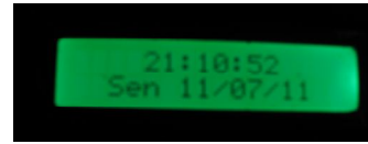
Gambar 12. Tampilan Hasil pengujian RTC DS1307
