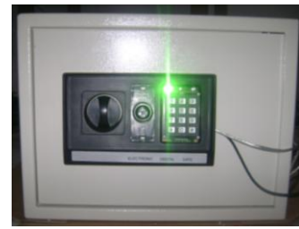
Gambar 17 Kondisi saat password benar atau brankas terbuka
