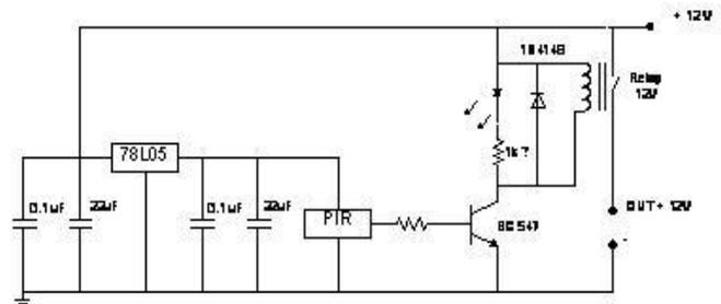
**Gambar 2. Gambar Rangkaian PIR**
