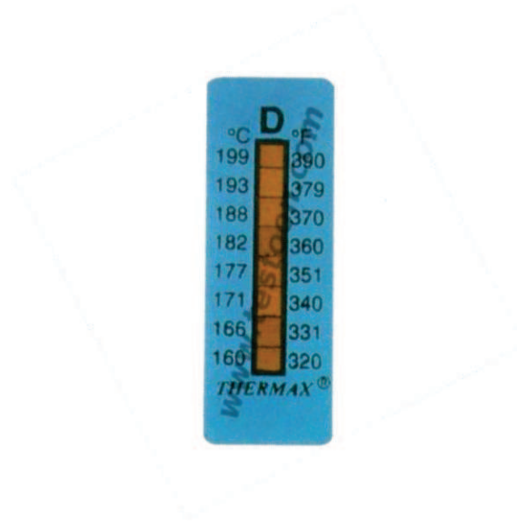
Figure 33: exemple de ruban thermomètre irréversible "thermax" dans la gamme 160-199°C
