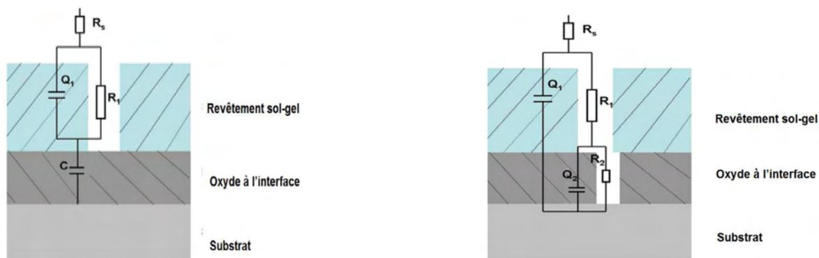
Figure 7 : Exemples de circuits équivalents schématisés dans le cas de l'étude de systèmes composés d'un revêtement sol-gel et d'une couche d'oxyde à l'interface entre le revêtement et le substrat.
