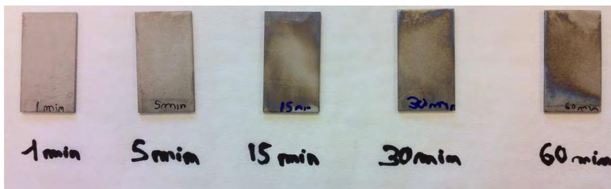
Figure 24: Photographies des couches de conversion réalisées sur l'acier inoxydable X13VD après différentes durées de traitement de conversion chimique.
