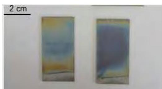
Figure 20 : Photographie de la couche de conversion Ce-Mn créée sur l'acier inoxydable X13VD
