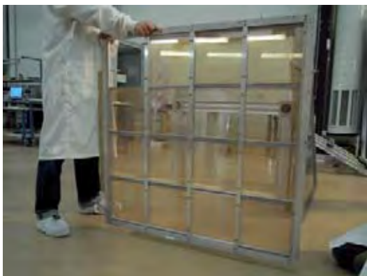
FIGURE I.37: Polariseur utilisé pour les tests de l'instrument intégré.
