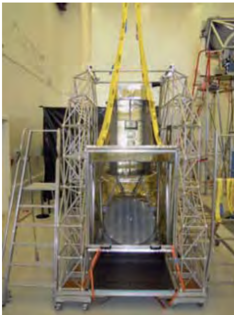
FIGURE I.33: Test d'insertion de la structure mécanique dans la nacelle, la structure est équipée des modèles de masse du photomètre et du miroir primaire.
