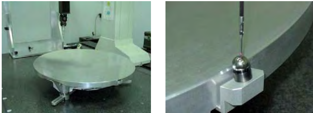
FIGURE III.7: Mesure tridimensionnelle effectuée avec contact sur le miroir primaire, a) configuration du miroir pendant la mesure, b) mesure tridimensionnelle d'une des billes de référence.
