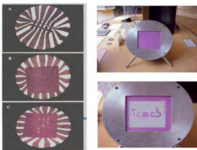
Figure A.1.2.2 : Exemple d'affichage à base de matériaux à TS.
