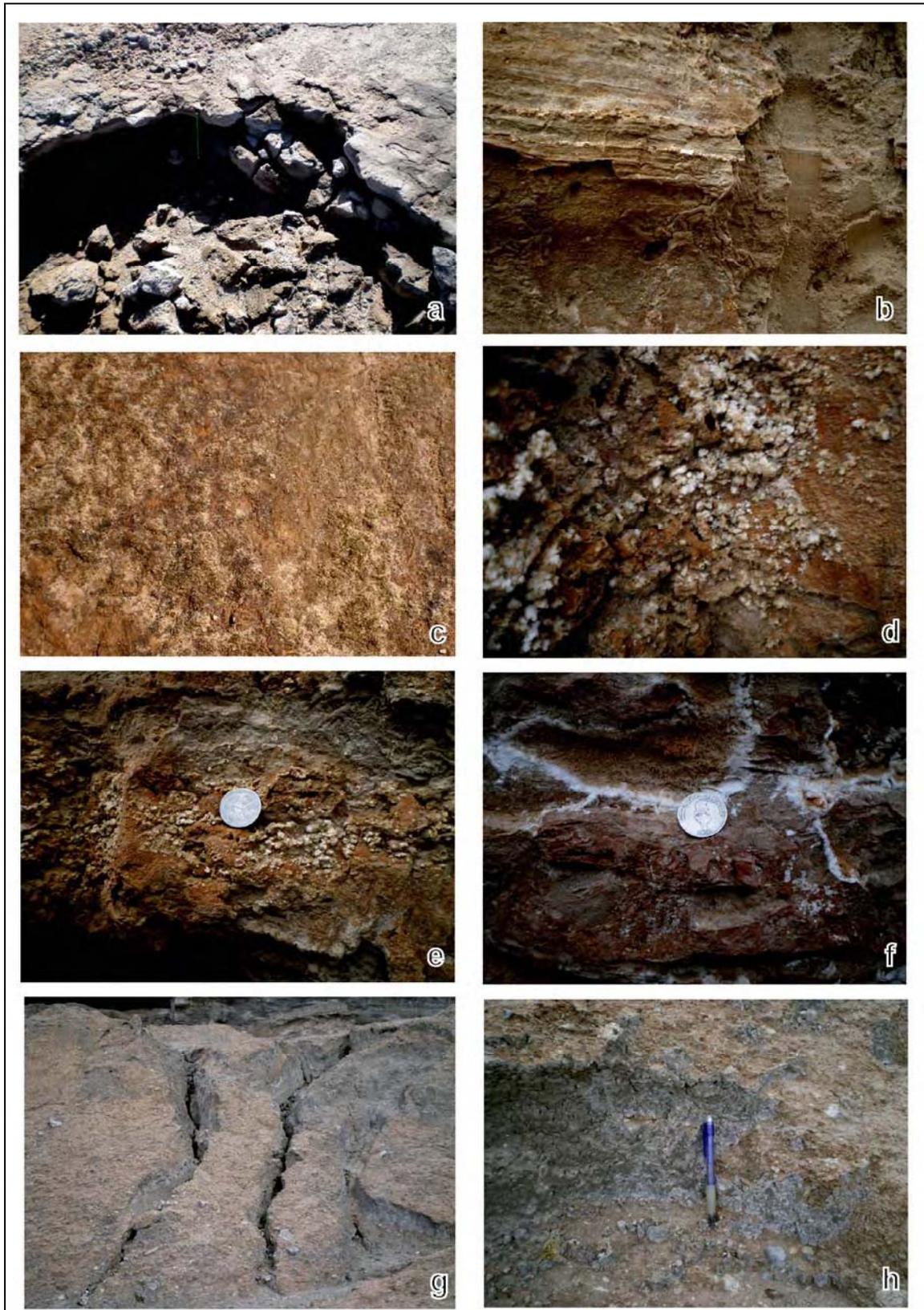
**Figure III.17 : Photos des croûtes et dépôts secondaires à la surface des terrils de déchets.**
