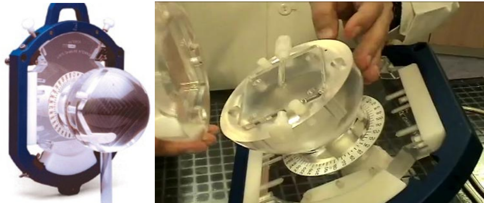
Figure 3.8 : Illustration du fantôme sphérique monté sur le cadre stéréotaxique (à gauche) et de la loge prévue pour la chambre PinPoint (à droite).
