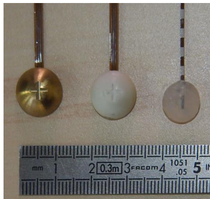
FIGURE 3.5 : De gauche à droite, illustration d'un MOSFET TN502RD, équipé du capuchon en laiton, du capuchon en RW3 et d'un microMOSFET TN502RDM-H, équipé du capuchon en bolus développé localement pour les mesures de surface.
