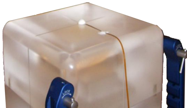
FIGURE 4.1 : Positionnement du détecteur MOSFET équipé de son capuchon RW3 à la surface du fantôme XWU-IMRT
