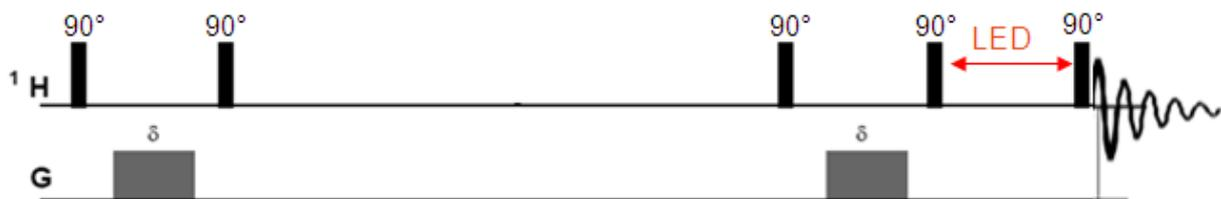
Figure 7. Schéma de la séquence d'impulsion de l'expérience d'écho de spin stimulé à gradients de champs pulsés avec un délai LED (LED-STE, longitudinal eddy current -Pulse Field Gradient Stimulated Echo).
