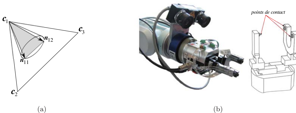
FIGURE 2.14 – (a) Intersection du cône de frottement avec le plan de contact. (b) Pince parallèle à trois points de contact.
