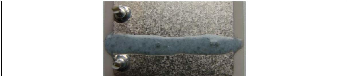
Fig. 3.5 : Echantillon vernis et réticulé à l'air ambiant
