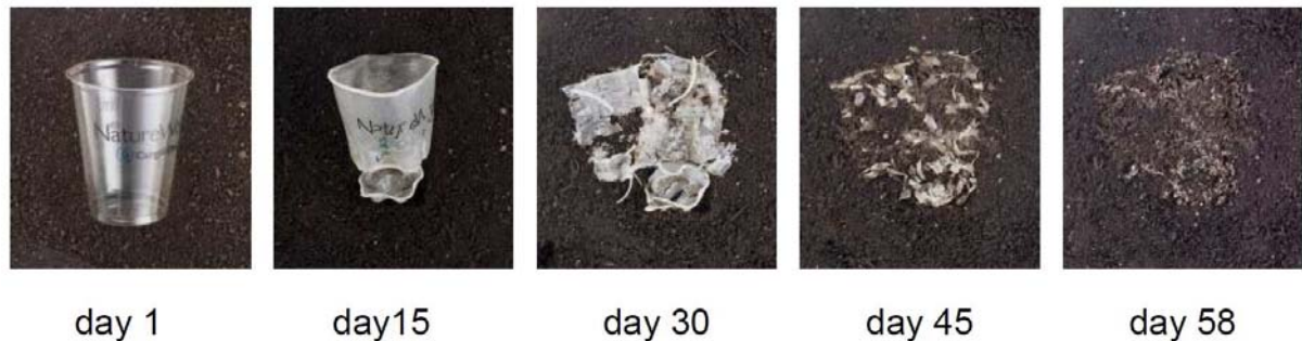
Figure 5 : Dégradation d'un gobelet en PLA dans un compost [8]
