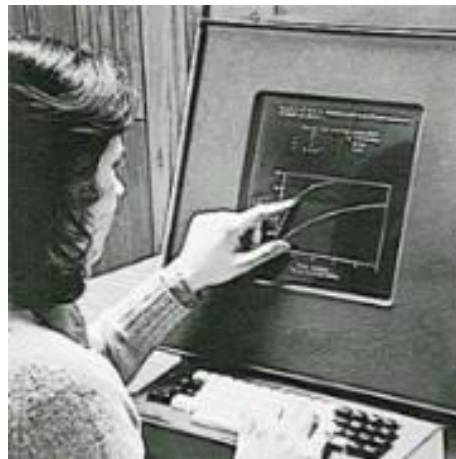
Figure 10 - Le terminal à écran tactile du PLATO IV 13
