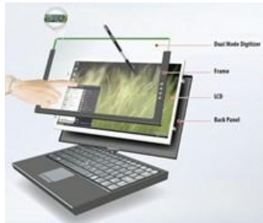
Figure 18 - Le système N-Trig 22
