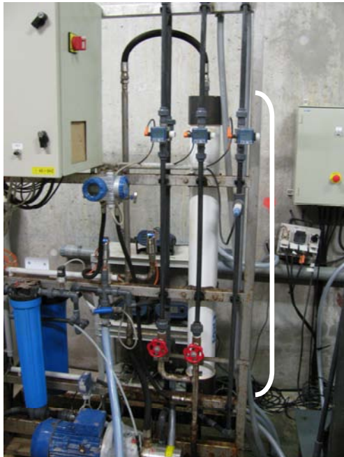
Figure VI.2 Photo de l'unité pilote d'osmose inverse comprenant un tube de pression positionné verticalement.
