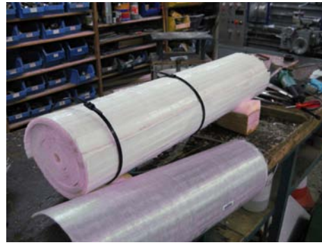
Feuillets autour du tube collecteur et coque en fibre de verre découpée
