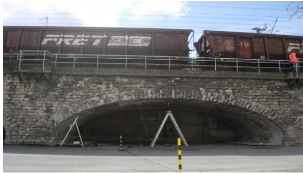
Figure 4-5 Mesures de flèches, d'accélération et de charges sous trafic réel.
