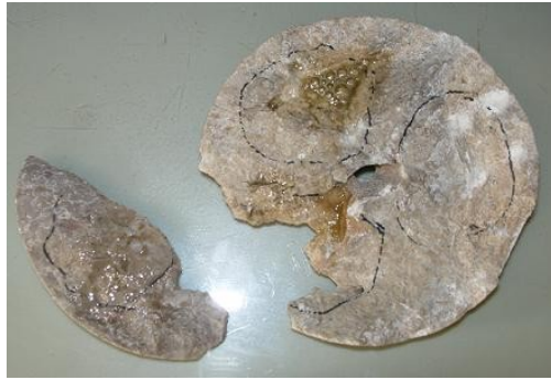
Figure 3-15 Test à l'acide sur les pierres de parement et intérieures.
