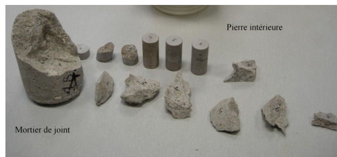
Figure 3-13 Echantillons utilisés pour les mesures de porosité et de masse volumique.
