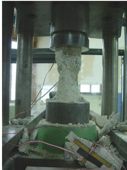
Figure 3-31 Faciès de rupture de l'éprouvette de mortier en compression uniaxiale.
