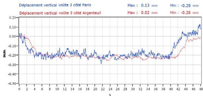
Figure 4-12 Mesure du déplacement vertical des piles sous le convoi le plus sollicitant.
