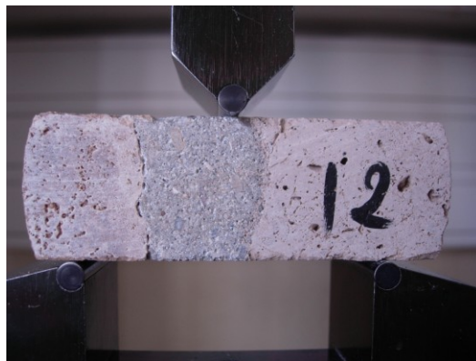
Figure 3-35 Dispositif d'essai pour la flexion d'un composite Pierre de parement - Mortier - Pierre de parement.
