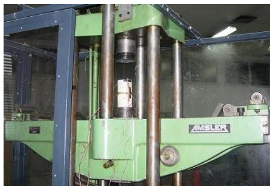
Figure 3-23 Dispositif d'essai pour le module d'élasticité et le coefficient de Poisson - Presse 600 kN.
