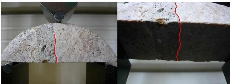
Figure 3-37 Propagation de la fissure entre le mortier et la pierre dans le composite lors de l'essai de flexion trois points.
