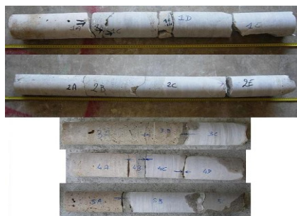
Figure 3-5 Présentation des carottes extraites lors des deux campagnes de carottages.
