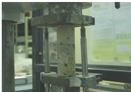
Figure 3-32 Essai de compression d'un composite Pierre - Mortier - Pierre.
