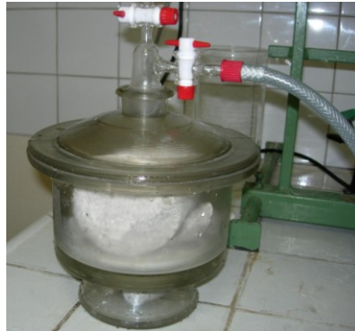
Figure 3-14 Enceinte de saturation en eau pour les mesures de porosité et de masse volumique.
