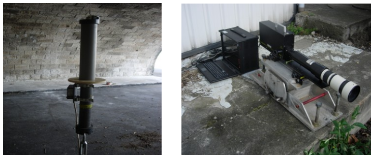
Figure 4-6 Mesures relatives par fil tendu (a) et absolues par caméra haute résolution (b).
