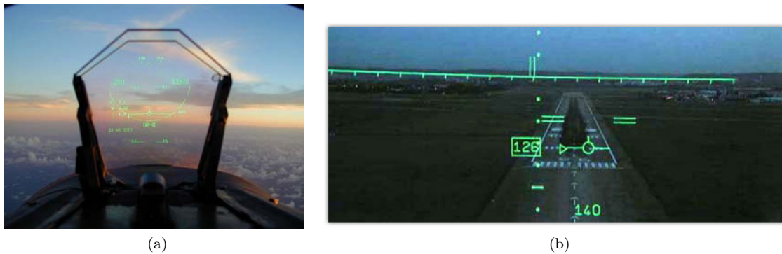
FIGURE 2: HUD installé dans un cockpit d'avion militaire. Les informations virtuelles coïncident avec le point de vue du pilote.
