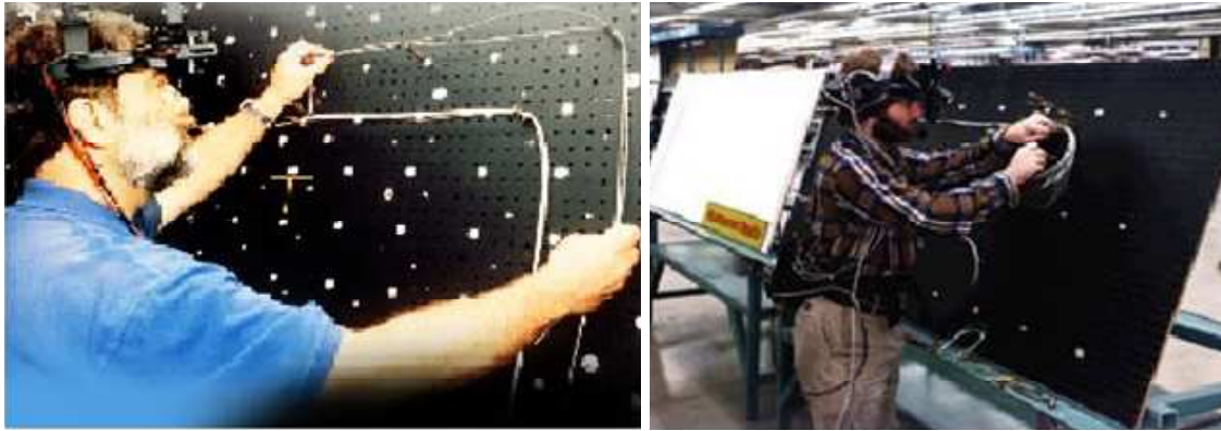
FIGURE 27: Câblage électrique assisté.
