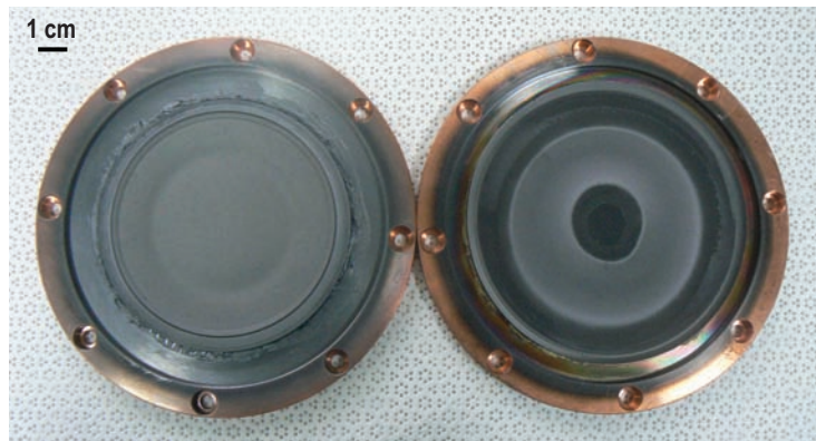
Figure IV.2 : Cibles \text{CuFeO}_2\text{:Mg} et \text{CuCrO}_2\text{:Mg} collées sur leur support de cuivre, présentant des anneaux de pulvérisation préférentielle liée à la configuration magnétron.
