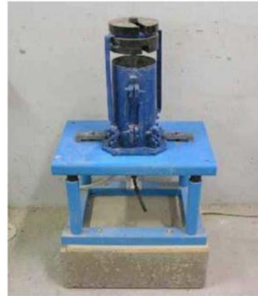
Figure 2-28: Dispositif de mesure de la compacité expérimentale [El Barrak, 2005]
