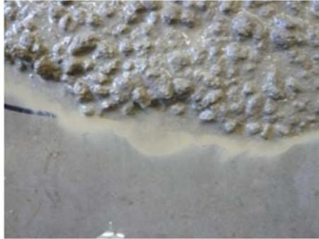
Figure 5-11: laitance en périphérie de la galette d'étalement
