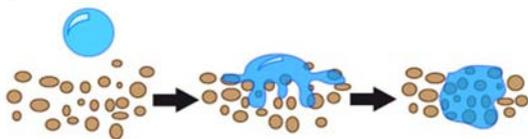
Mouillage et nucléation : l'eau en contact avec la poudre forme des granules à l'intérieur desquels les pores sont saturés en eau. Si le volume d'eau reste insuffisant, les granules, secs en surface ne vont pas s'associer.
