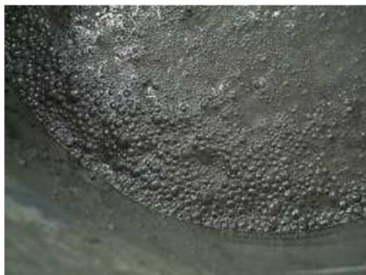
Figure 1-1: observation du bullage d'une chape autonivellante (immédiatement après malaxage)
