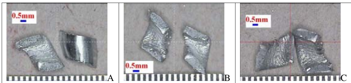
FIGURE 4.13 – Images des formes des copeaux, A. Copeaux obtenus à sec avec la plaquette S4 après 30000 cm 3 , B. Copeaux obtenus à sec avec la plaquette O1 après 30000 cm 3 , C. Copeaux obtenus avec lubrifiant avec la plaquette O1 après 19000 cm 3 .
