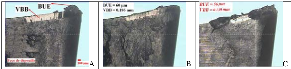
FIGURE 4.7 – BUE maximale, A. Plaquette (S4) après 30000 cm 3 de matière usinée à sec, B. Plaquette (O1) après 30000 cm 3 de matière usinée à sec, C. Plaquette (O1) après 19000 cm 3 de matière usinée avec le lubrifiant.
