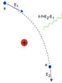
FIGURE 1.7 Schéma de l'émission Bremsstrahlung.
