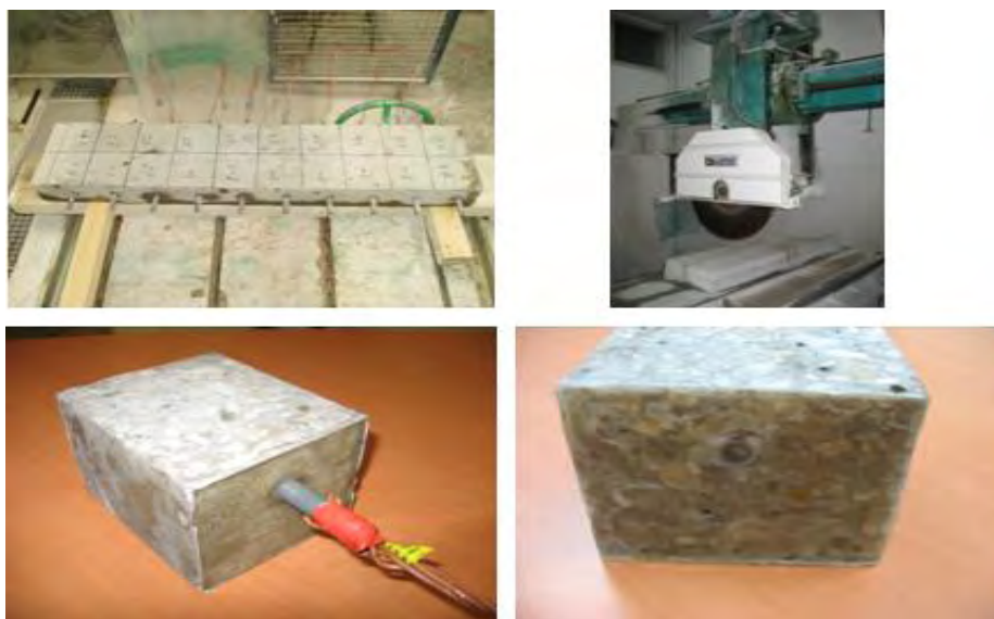
Figure II-3 : Eprouvettes de petites tailles après sciage des murs
