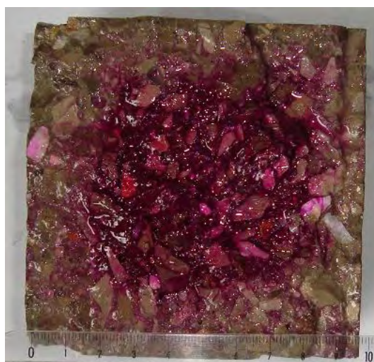
Figure III-32 : Front de carbonatation obtenu sur un cube de béton après 120 jours en enceinte de carbonatation accélérée
