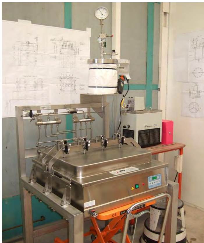
Figure II-14 : Enceinte utilisée au CEA pour l'essai « eau de site » à 50 °C
