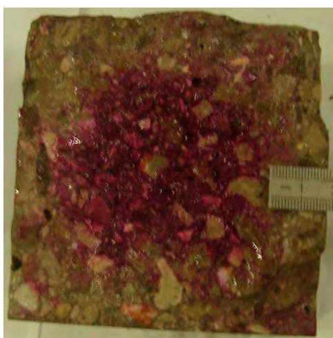
Figure III-9 : Front de carbonatation obtenu sur un cube de béton après 16 semaines en enceinte de carbonatation accélérée
