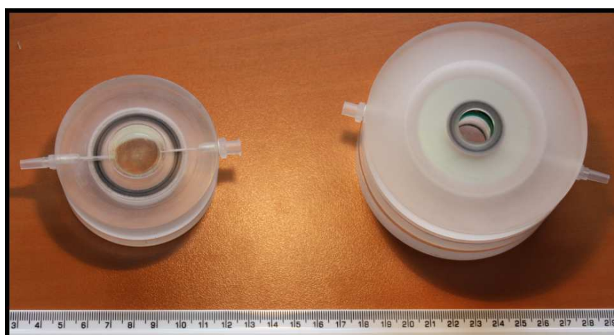
Figure II.9 : photographie des deux cellules d'ablation optimisées pour l'étude des inclusions fluides. A gauche, cellule à volume interne = 1,6 \text{ cm}^3 . A droite, volume interne = 2,3 \text{ cm}^3
