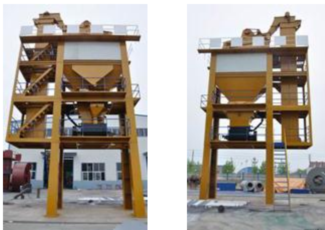
Slika 10: Mešalni stolp – levo: sprednja stran, desno: zadnja stran stolpa (SINOSUN Group, 2013)
