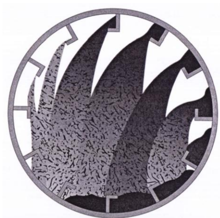
Slika 6: Prerez sušilnega bobna z lopaticami (Asphalt Handbook, 2010, str. 320)
