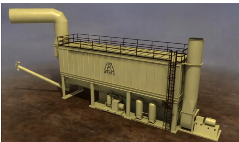
Slika 9: Sistem za vračanje lastnega polnila z vrečastim zbiralnikom (Astec Videos, 2013)
