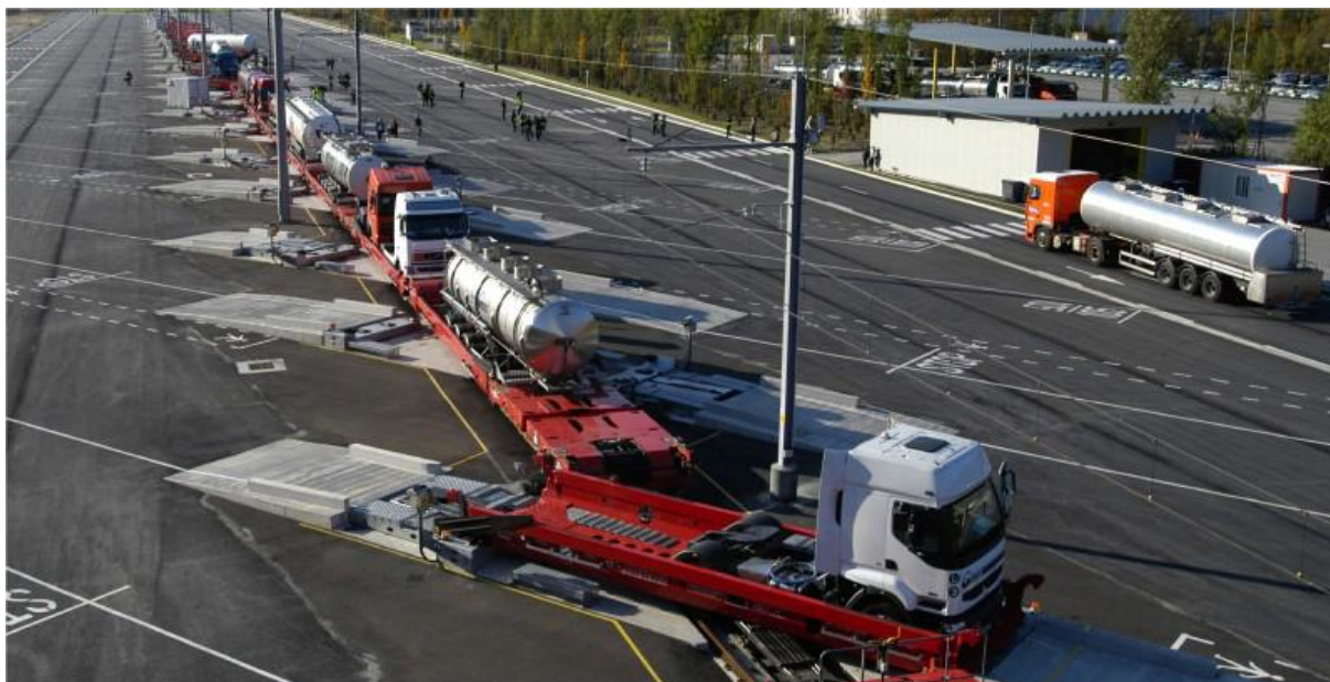
Slika 4.5: Terminal horizontalnega vzporednega natovarjanja polprikolic in prikolic-tehnologija Modalohr (Modalohr, 2007)
