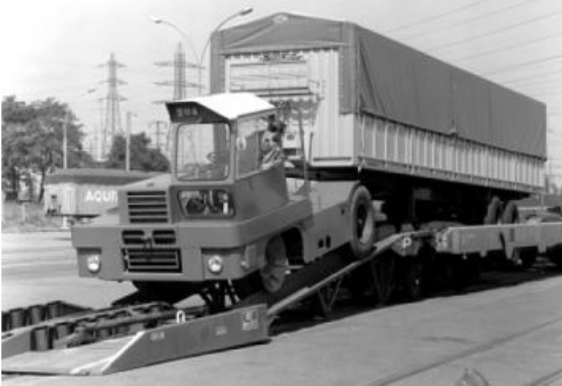
Slika 4.2: Horizontalno zaporedno natovarjanje polprikolice pri oprtnem sistemu tehnologije »B« (Osnove transportnih tehnologij, 2009)
