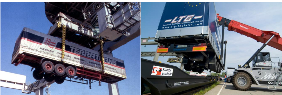
Slika 4.3 in slika 4.4: Primera vertikalnega natovarjanja polprikolic tehnologije »B« (Kombiverkehr, 2012)
