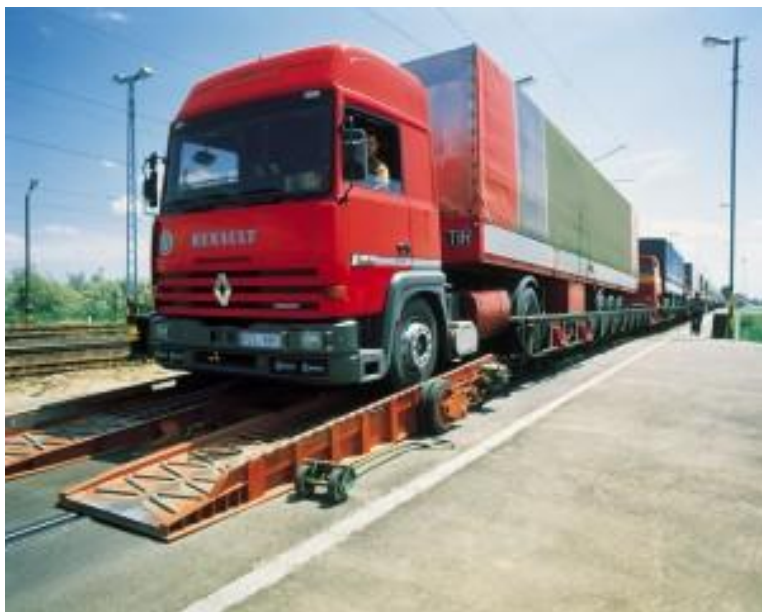
Slika 4.1: Primer oprtnega sistema tehnologije »A« (»potujoča avtocesta«) (Hungarokombi, 2012)
