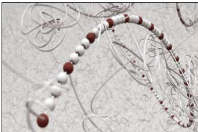
Slika 2.6: Shematičen prikaz molekule SP polikarboksilatnega tipa (Zvenik, 2010)
