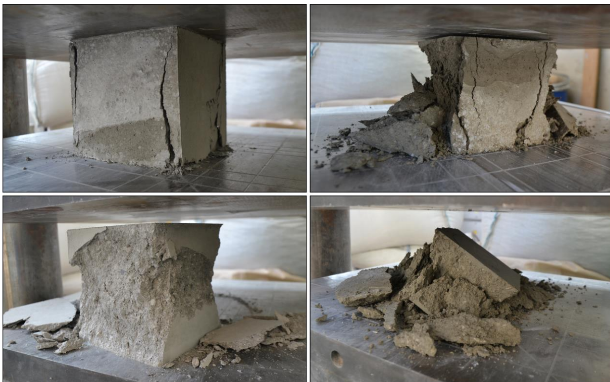
Slika 4.7: Porušitev kock s polikarboksilatnim (levo) in polifosfonatnim (desno) superplastifikatorjem po obremenitvi v hidravlični stiskalnici, 24 ur po vlitju
